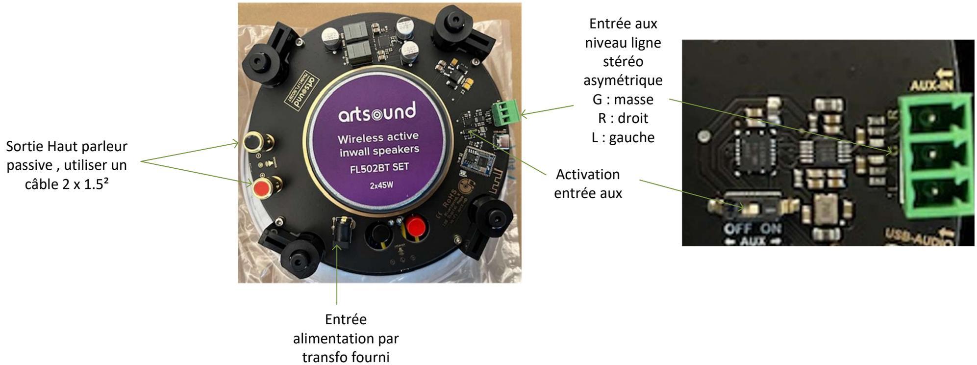
Priorités : BT > AUX par détection de modulation : la priorité nécessite un niveau minimum
